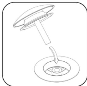
Verificare innanzitutto che il foro centrale nella griglia sia sufficiente per l'introduzione di "TAPPAGUASTI". Prima di procedere all'eventuale operazione di allargatura del foro, assicurarsi che gli spessori del perno siano sufficienti a permettere tale operazione.
