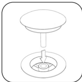
Verifica del posizionamento del TAPPAGUASTI nello scarico.
