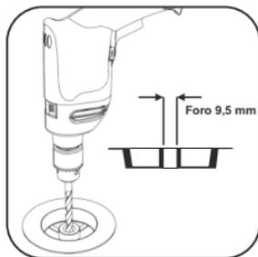
In caso di necessità, allargare il foro con una punta da trapano di Ø9,5 mm. Questa operazione deve essere eseguita da un idraulico professionista, che conosce il tipo di scarico installato e quindi grado di valutare la fattibilità di questa operazione.
