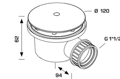
Flangia in plastica avvitabile (svasata o piana). Coperchio in ABS rivestito in acciaio inox
